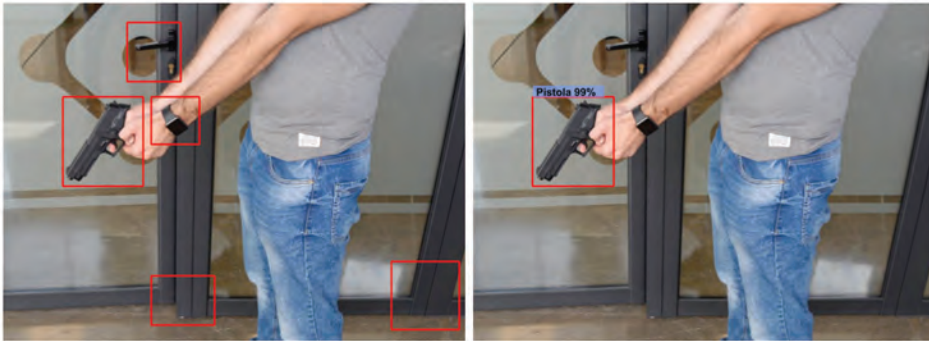
Figura 2. Etapas del modelo de detección de objetos, a la izquierda proposición de regiones y a la derecha la detección final de la red CNN
